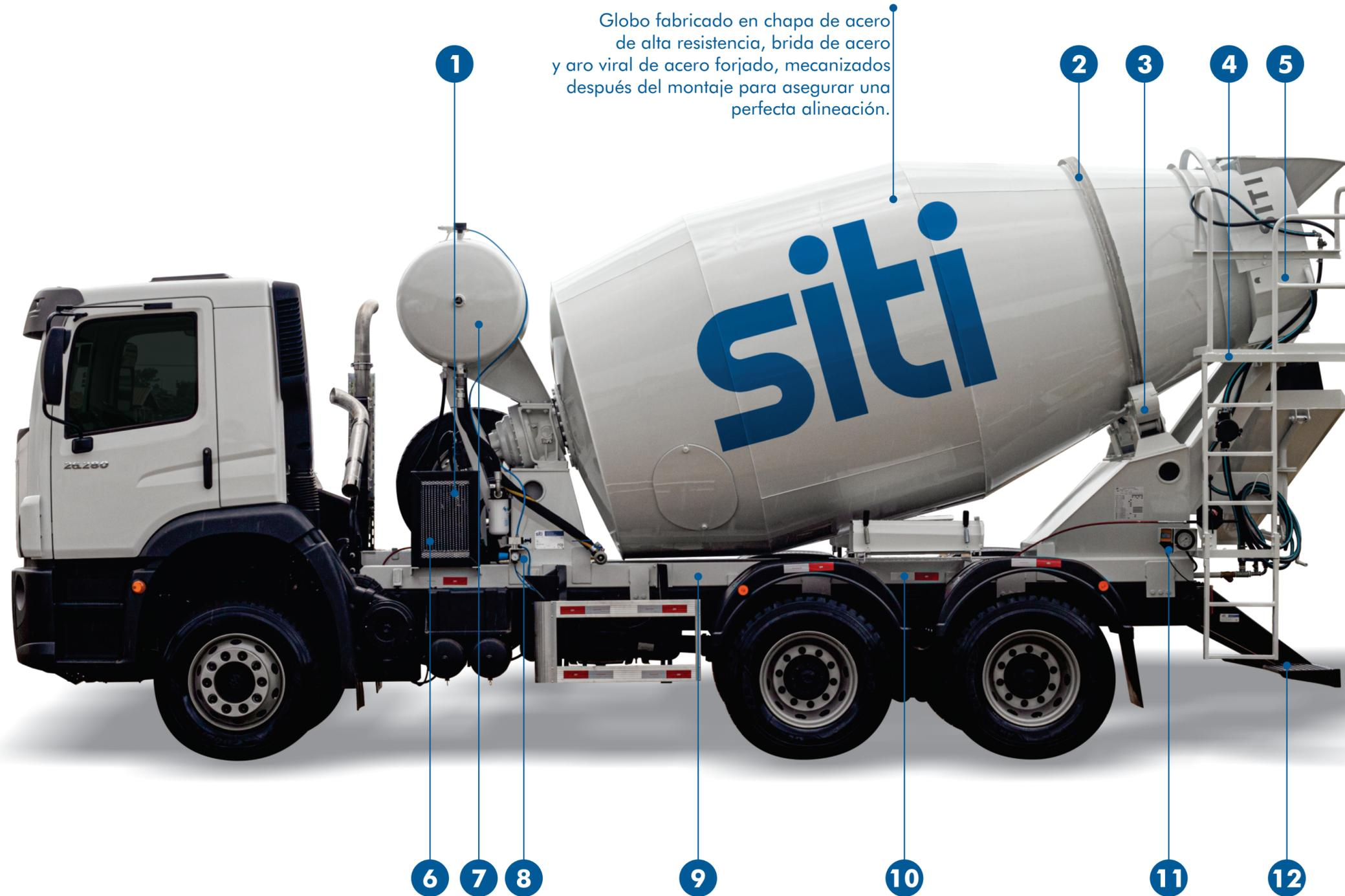
Deposito con capacidad para 600 litros de agua, presurizada con 5 kg/cm<sup>2</sup>, con válvula de seguridad, registro de caudal de agua por hidrómetro por lectura de 0 a 500 litros y manguera para lavado.
