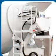
Tolva de descarga con diseño cerrado, evitando el escape de material.
