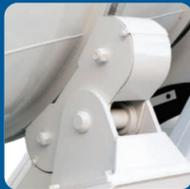
Único en el mercado fabricado con sistema de doble apoyo de rodillos a cada lado (04 piezas en el total) montados sobre rodamientos de 1° línea con sellos.
