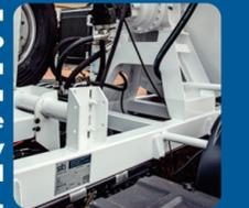
Chasis fabricado en una sola pieza, evitando montajes y tornillos, apuntando mayor estabilidad al equipo.
