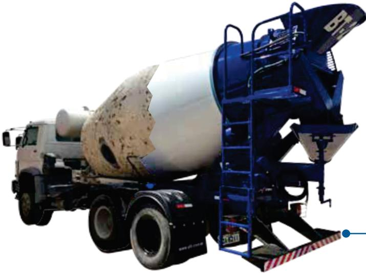
Con más de 30 años de experiencia en el mercado de las hormigoneras, garantizamos una reforma de calidad. Nuestro proceso de restauración incluye la preparación del granallado de acero, que elimina prácticamente el 100% de las impurezas de la superficie de la chapa y aumenta la durabilidad de la pintura.
